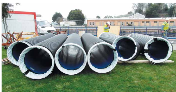
Hydrotub XL Ø750 mm avec joints electrofusion.
