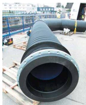
Fabrication de pièces spéciales pré montées d'un seul tenant.
